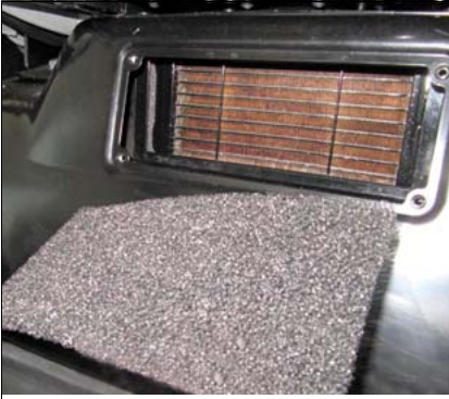
Joon. 264: Välisõhufiltri paigaldamine
